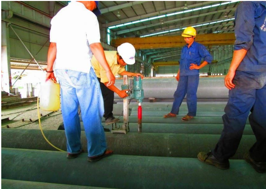
Khoan lõi thí nghiệm bê tông cọc
