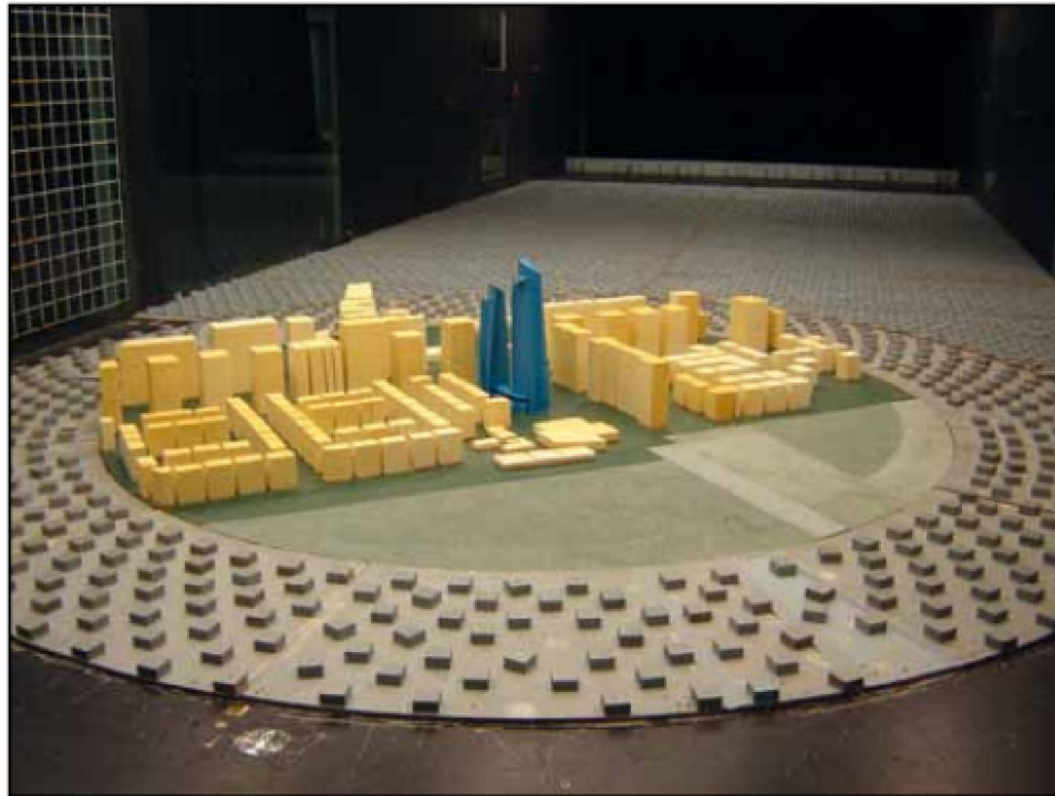
Hình 9.6 – Khu vực xung quanh mô hình ống thổi khí động.
