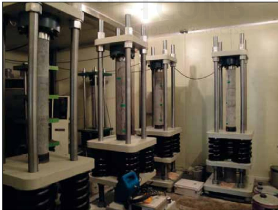
Hình 11.4 - Đo biến dạng từ biến từ các mẫu bê tông trong buồng khí hậu.
