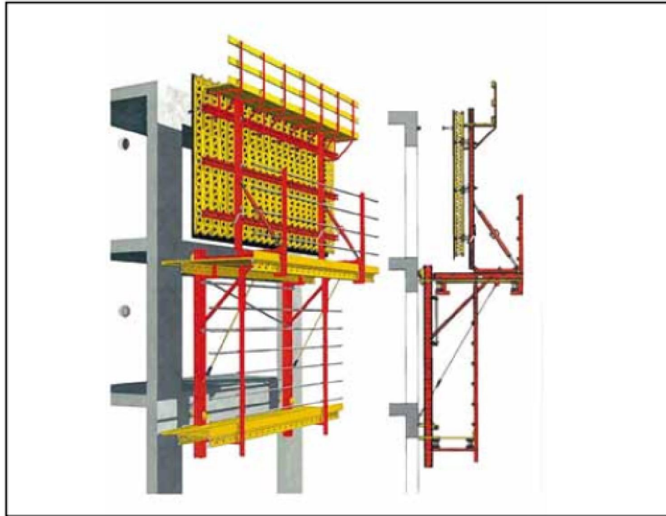
Figure 6.3 – Ví dụ về hệ ván khuôn nhấc bằng cầu
