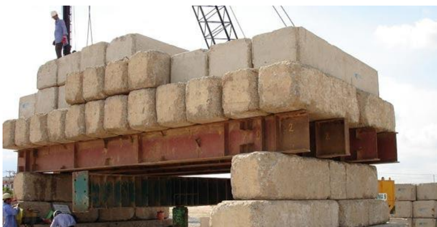
Hình 1. Thí nghiệm xác định sức chịu tải cọc bằng phương pháp nén tĩnh [6, 10]
