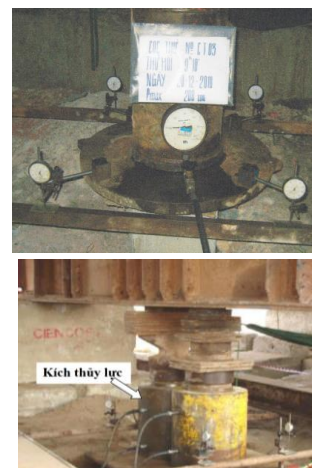
Hình 1. Thí nghiệm xác định sức chịu tải cọc bằng phương pháp nén tĩnh [6, 10]
