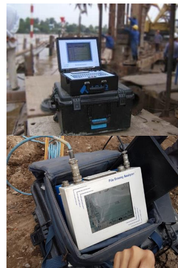
Hình 4. Thử tải cọc và thiết bị phân tích thí nghiệm thử động biến dạng lớn PDA [11]
