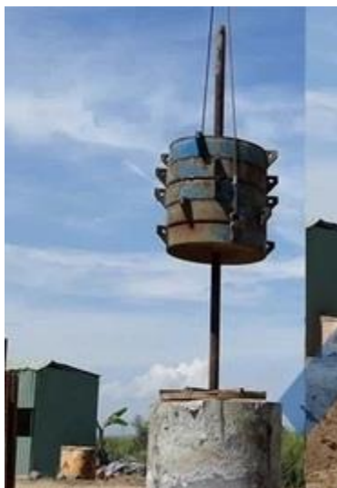
Hình 4. Thử tải cọc và thiết bị phân tích thí nghiệm thử động biến dạng lớn PDA [11]
